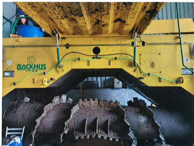
Fot.2 Instalacja dozowania środka do dezodoryzacji na przerzucarce Backhus
