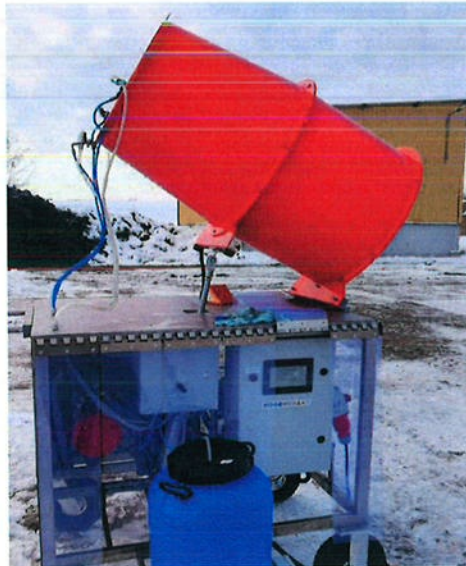
Fot.5 Mobilna maszyna do dezodoryzacji
